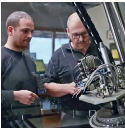
Steivan und Albert Peer bei der Kontrolle der Greifer für das automatische Beladen des CNC-Schärfautomaten.
