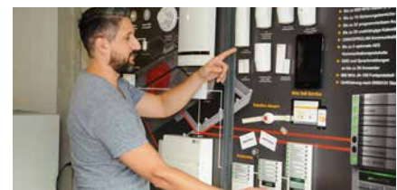
Ivo Simon erklärt seine Meldeanlagen: Störungen am System gehen auf seinem Handy ein und nötige Aktionen werden eingeleitet. Alarmmeldungen hingegen werden je nach Kundenwunsch auf Privatnummern oder auf Alarmempfangszentralen geschaltet.
