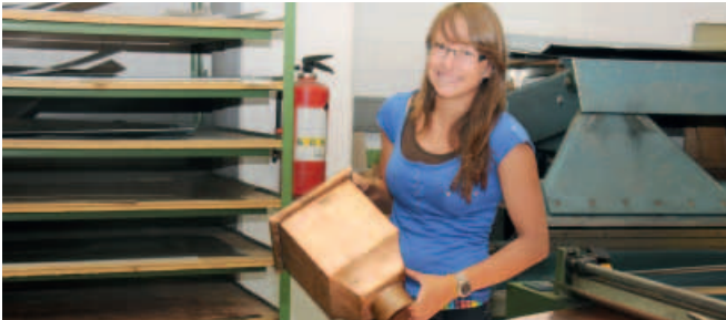
Die junge Spenglerin biegt aus flachem Kupfer-, Chromnickelstahl- oder Titanzinkblech millimetergenaue Körper.
